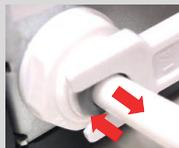
Drücken Sie den weißen Ring mit Daumen und Zeigefinger [oder dem Schlüssel für Steckverbinder] nach innen gedrückt [rot umrandetes Bild] und ziehen Sie gleichzeitig den Schlauch heraus.
