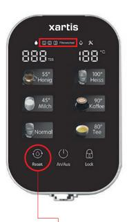
→ Stecken Sie den neuen Filter in die Öffnung und drehen diesen im Uhrzeigersinn fest. ▶ Halten Sie den "Reset" Button für etwa 3 Sekunden gedrückt bis die Anlage 1x piept und das erste Filterelement am Display rot blinkt.
